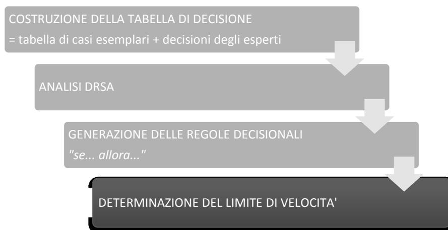
FIGURA 9-1 – RAPPRESENTAZIONE SCHEMATICA DEL PROCESSO DI DETERMINAZIONE DEI LIMITI DI VELOCITÀ
