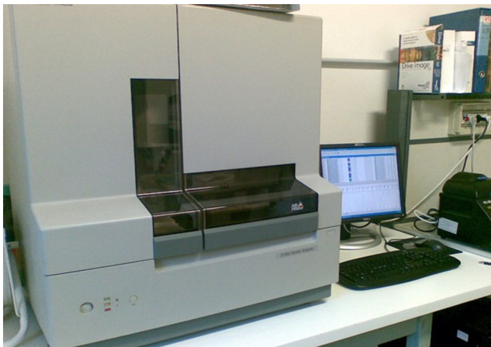
Figura : Sequenziatore automatico a capillare ABI 310 (Applied-Biosystems)
