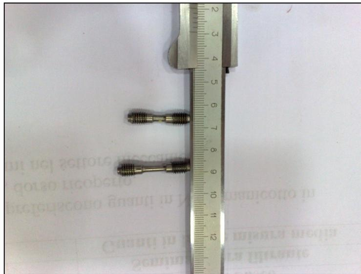
**Figura C.2 - Provini per test ad elevata velocità di deformazione in tensione su Hopkinson Bar**
