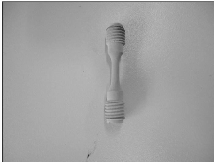
**Figura H.13 – Provino filettato utilizzato per test quasi statici in trazione**
