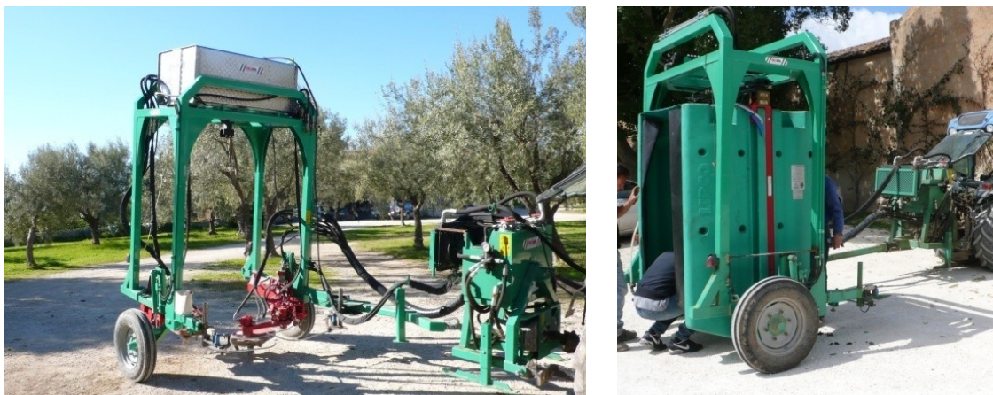
Fig. 9.6 – Portale scavallante multifunzione con gruppo di alimentazione: foto sx con coppia di rotofrese (I allestimento, con serbatoio nella sommità) foto dx con tunnel
