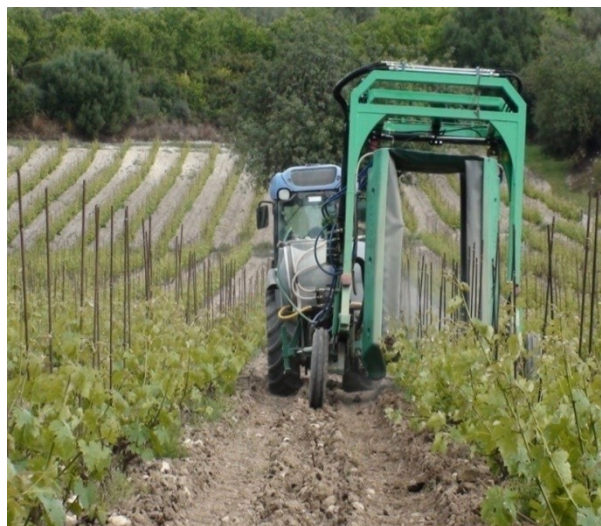
Fig. 9.13 – Prove in campo con irroratrice a tunnel
