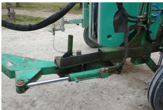
Fig. 9.5 – Barra di traino con pistone idraulico in grado di mantenere il telaio nella traiettoria voluta
