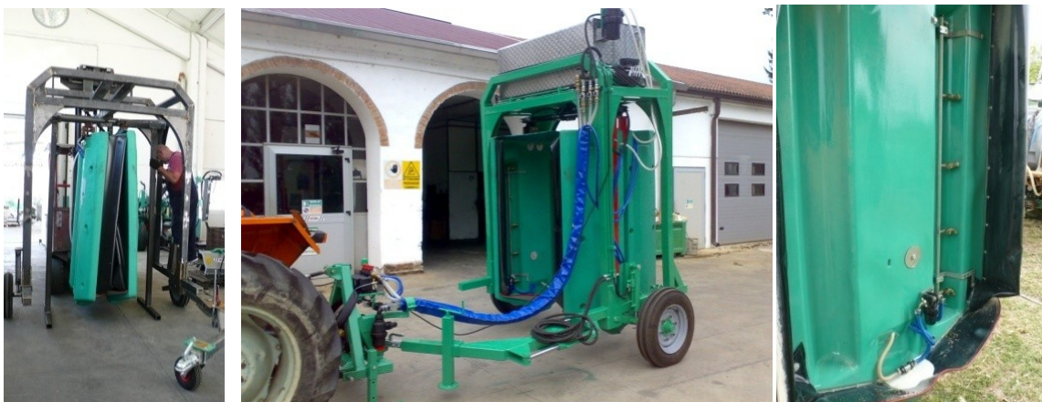
Fig. 9.10 – Sistema di distribuzione a tunnel e sue componenti: pareti captanti, barra portagelli e vaschetta di recupero.
