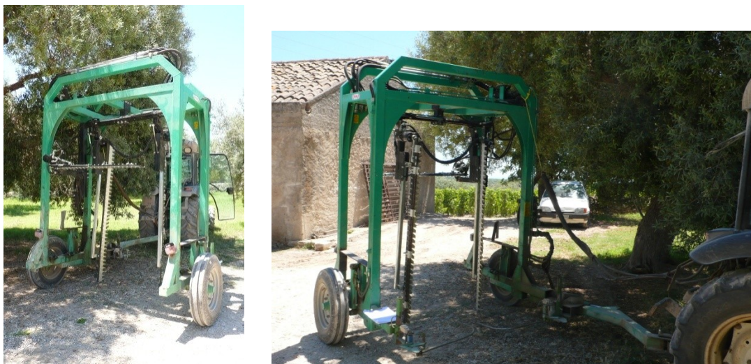
Fig. 9.8 – Applicazioni al telaio: Barre cimatrici
