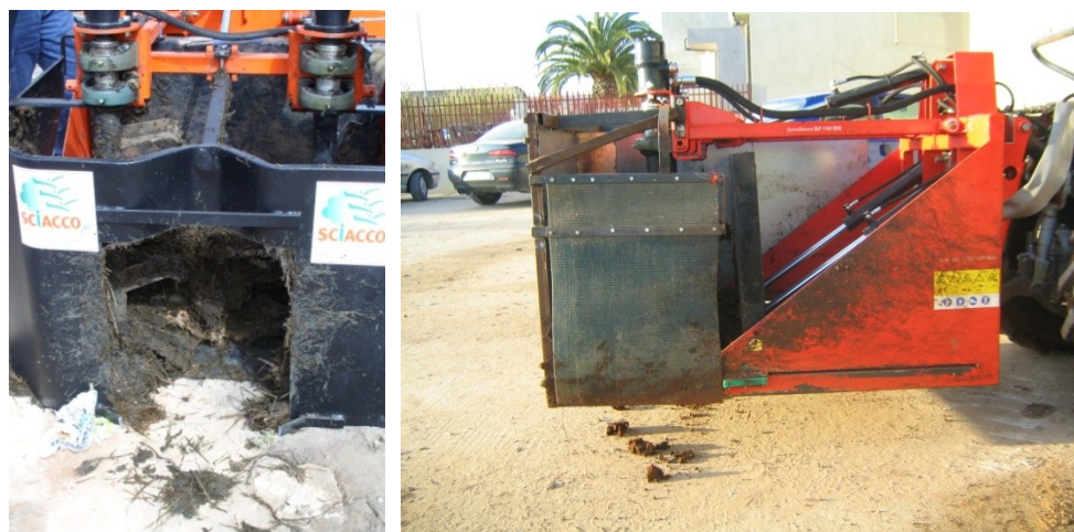
Fig. 8.6 - Spandicompost - distributore localizzato posteriore e distributore laterale
