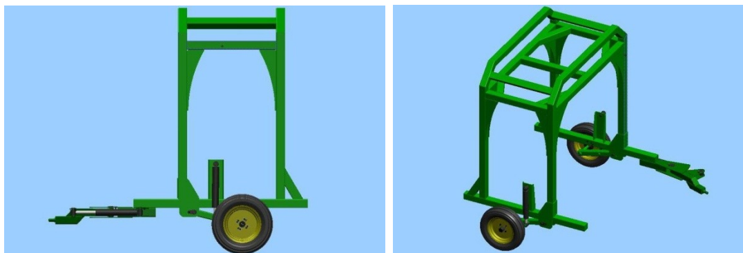
Fig. 9.3– Il Prototipo Portale Scavallante Trainato
