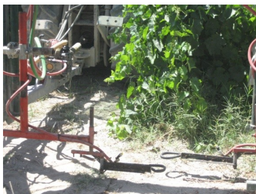
Fig. 9.2 Dispositivo localizzatore artigianale per irrorazione parte produttiva.
