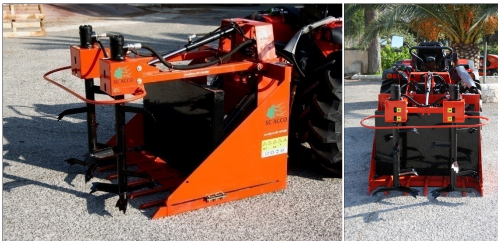
Fig.8.2 – Macchina spandiletame/spandicompost, prospetto laterale e posteriore
