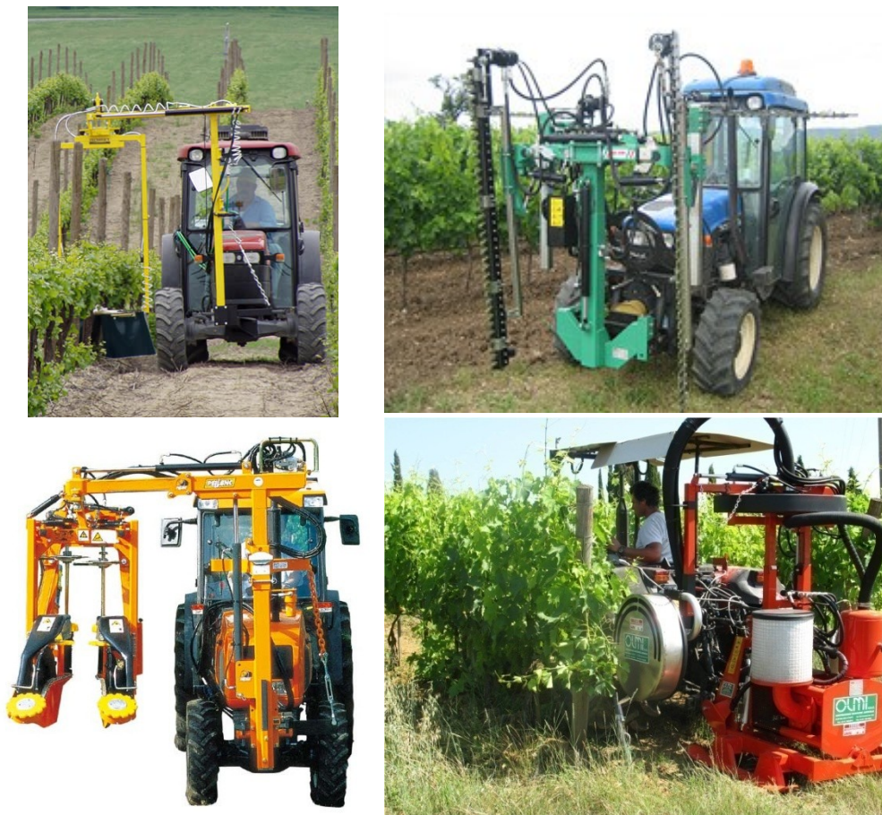
Fig. 2.4 – Spollonatrice chimica, cimatrice, legatrice e sfogliatrice.
