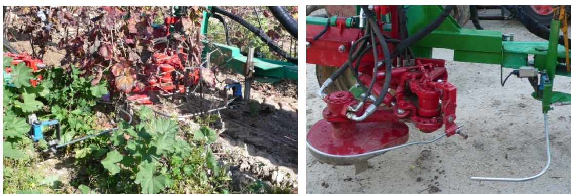
Fig.9.7 - I tastatori posti frontalmente al telaio
