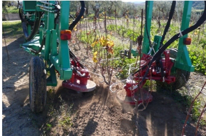
Fig. 9.9 - Applicazioni al telaio: coppia di zappatrici interceppo
