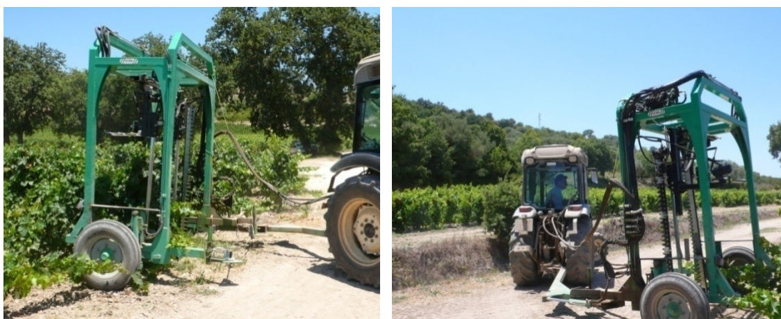
Fig. 9.17 – Manovre del portale mentre esegue la cimatura.
