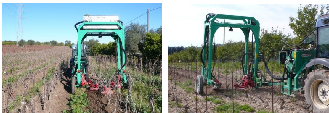
Fig. 9.15 - Lavorazione terreno con interceppo.
