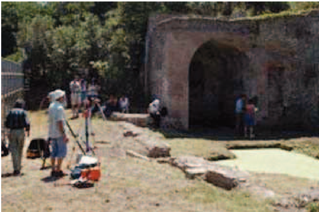
Fig. 4 - Acquisizione tramite Laser Scanner 3D (Da: www.appia.itabc.cnr.it ).
