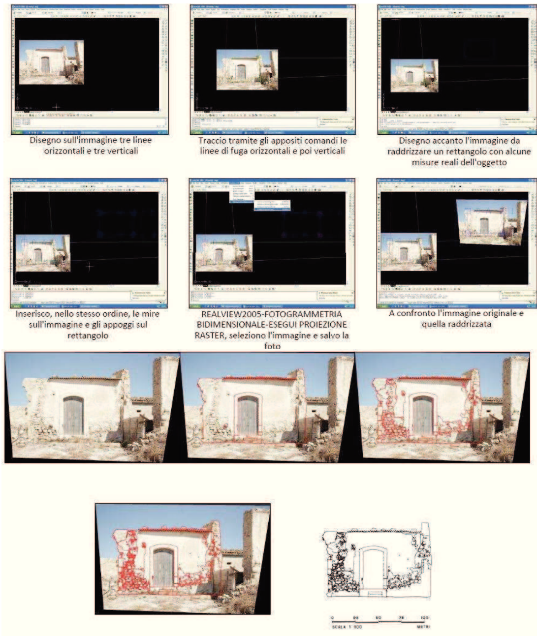
Fig. 40 – San Lorenzo Vecchio. Fotoraddrizzamento e restituzione bidimensionale di parte del prospetto interno alla corte, lato nord (restituzioni di Laura Privitera).
