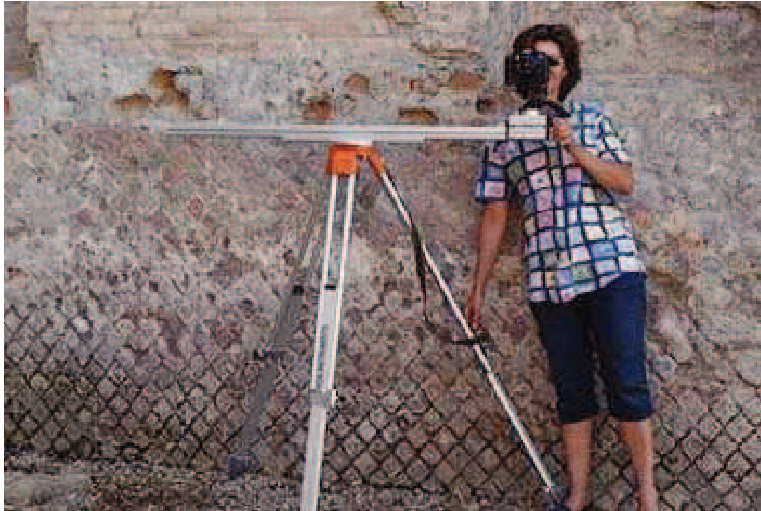
Fig. 3 - Acquisizione fotografica di coppie estereoscopiche con attrezzatura Menci (Da: www.appia.itabc.cnr.it ).
