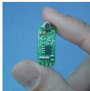
FIGURA 9: TERMOMETRO DIGITALE A INFRAROSSI
