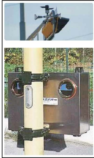
Fig. 17 - Sistemi di input: contatori di traffico
