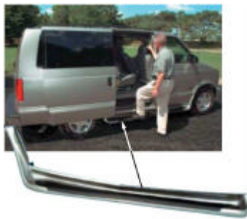
Figura 1.15 Van General Motors con pedana in nanocomposito
