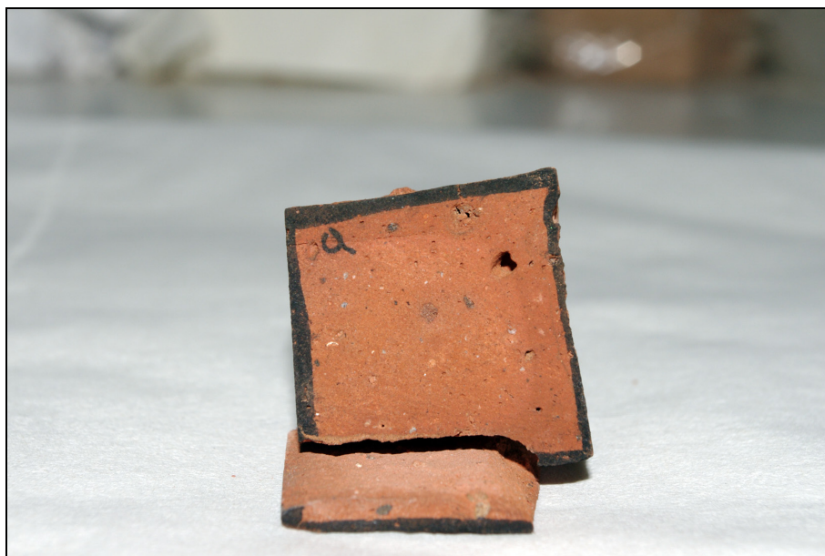
Figura 7.30 – Frattura in provino senza smagrante cotto a 1000 °C.
