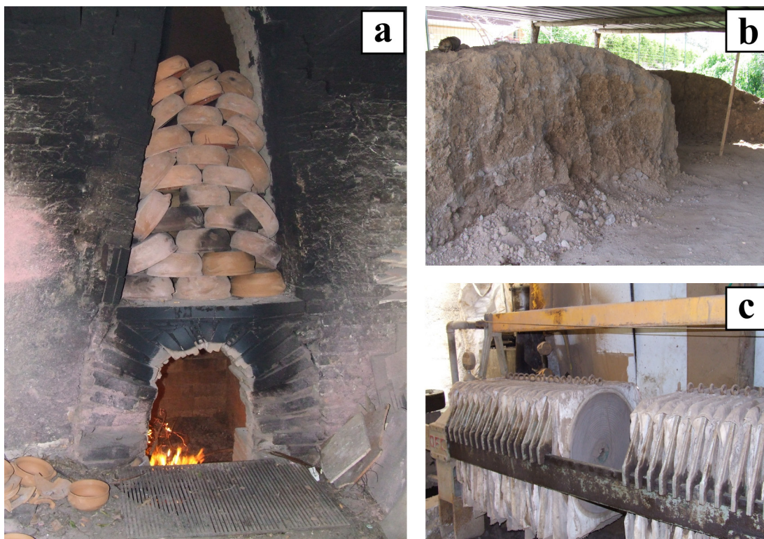
Figura 3.2 – Cascano di Sessa Aurunca, fornace “Vellone”. a) Fornace con tegami in cottura. b) argilla in deposito. c) Filtropressa.
