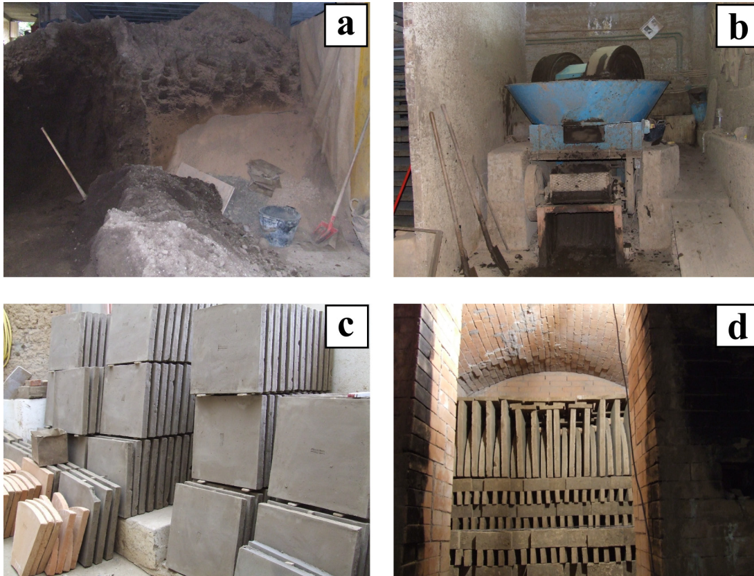
Figura 3.3 – Forni “Aversa” a Sant’Agnello. a) Materiale argilloso in deposito. b) Molazza per la preparazione dell’impasto. c) Mattoni in essiccazione. d) Fornace con mattoni in attesa di cottura.
