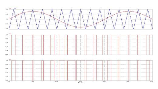
Fig. 60: Bipolar PWM modulation
