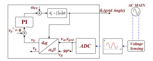
Fig. 48: dq-PLL structure
