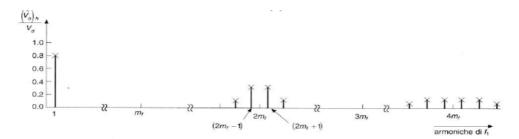
Fig. 63: Unipolar PWM modulation mf=15 e ma=0.8.
