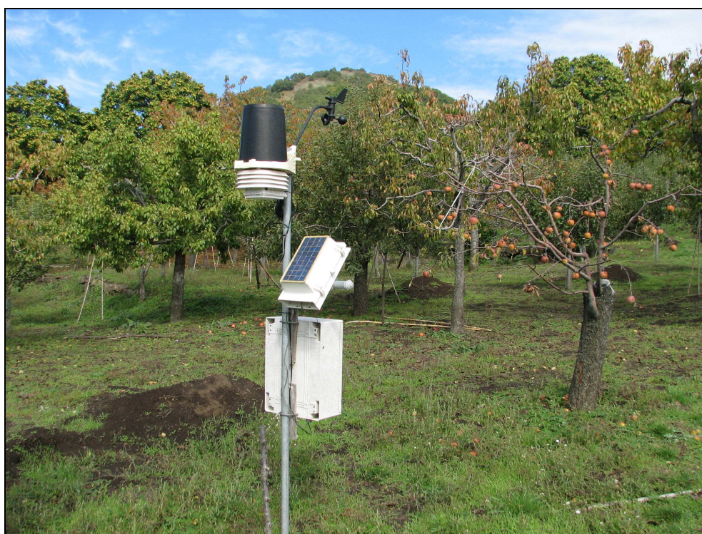
Fig. 2.2.2 –Stazione termopluviometrica sita all'interno del frutteto biologico (Foto R. Boemi).
