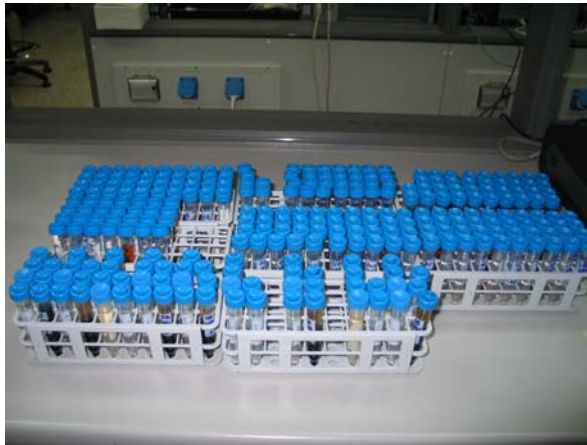
Figura 70. Immagine di parte degli eluati prodotti dall'applicazione della procedura di estrazione sequenziale.
