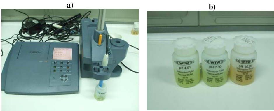
Figura 82. Fase di taratura del pHmetro (a); soluzioni tampone per la taratura (b).
