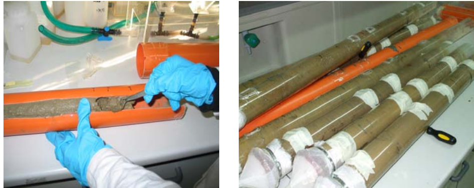
Figura 64. Prelievo dei campioni di terreno, da sottoporre ad estrazione sequenziale, dalle colonne A, B e C.
