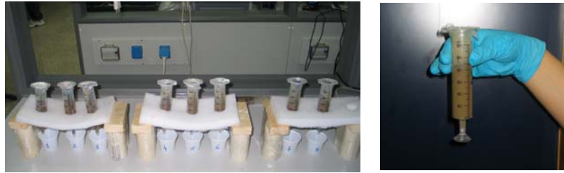
Figura 73. Siringhe di terreno trattate con EDTA e particolare siringa nella fase di interruzione del flusso.
