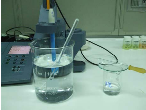
Figura 81. Aggiustamento del pH della soluzione mediante aggiunta di acido e monitoraggio contemporaneo della variazione del pH.
