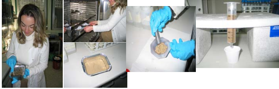
Figura 72. Sperimentazione su siringhe: preparazione del terreno prima dell'impaccamento e particolare di una delle siringhe impaccate.
