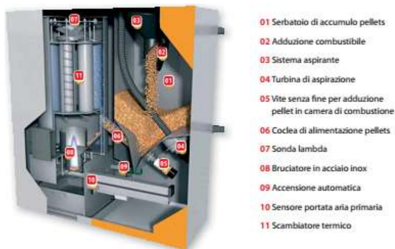
Figura 101: Funzionamento di una caldaia a pellets
