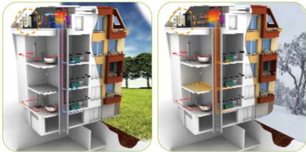
Figura 154: Esempi di installazione di una pompa di calore a gas
