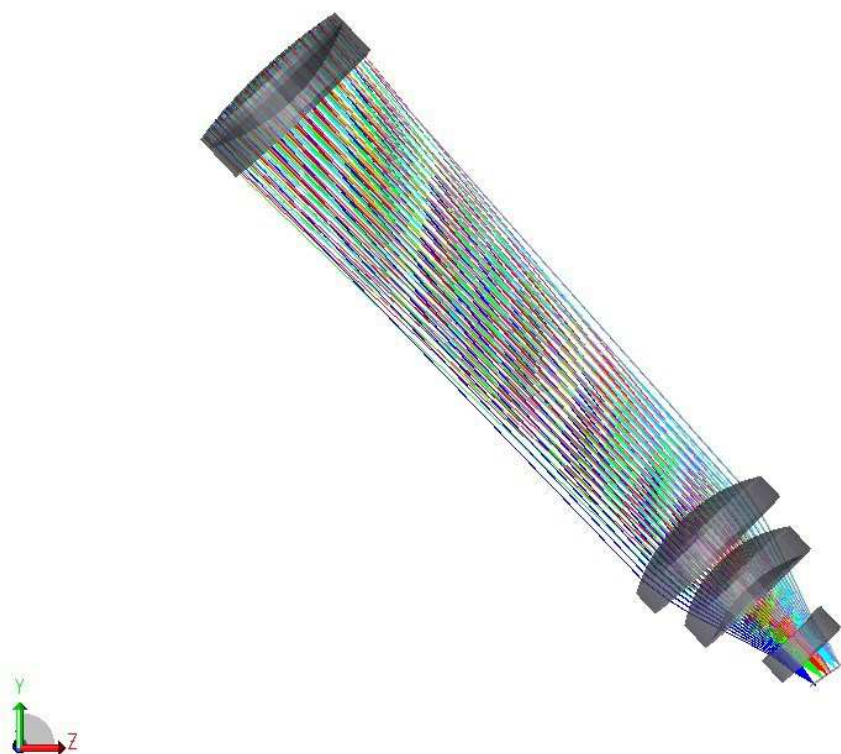
Figura 1.13: Disegno ottico della camera F/2.1 di CAOS.
