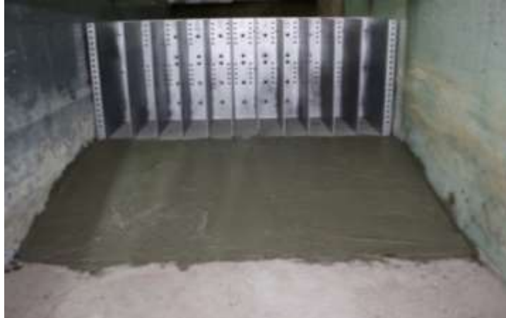
Figura 4.5: Parte fissa del modello di laboratorio posta su una rampa di pendenza s 1:6.
