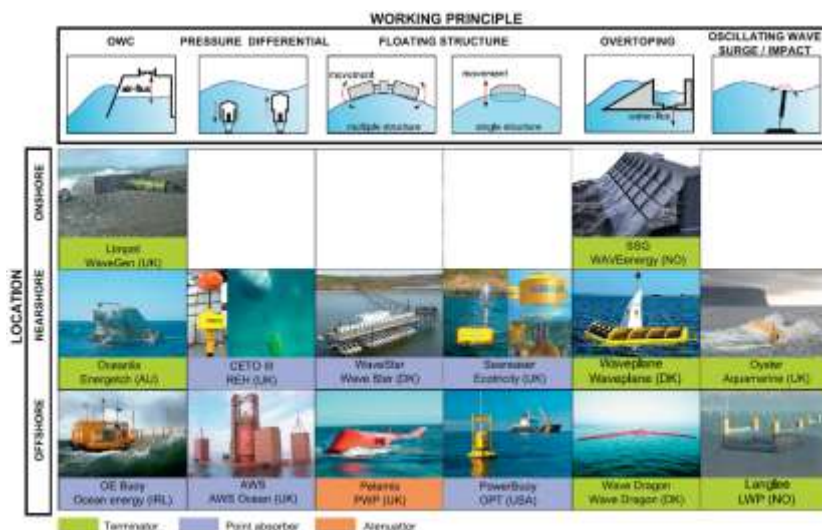
Figura 2.9: Classificazione dei WECs proposta da Lopez et al. (2013) in funzione della posizione rispetto alla costa (ordinata), del principio di funzionamento (ascissa) e della posizione rispetto alla direzione di provenienza delle onde (variazione di colori).
