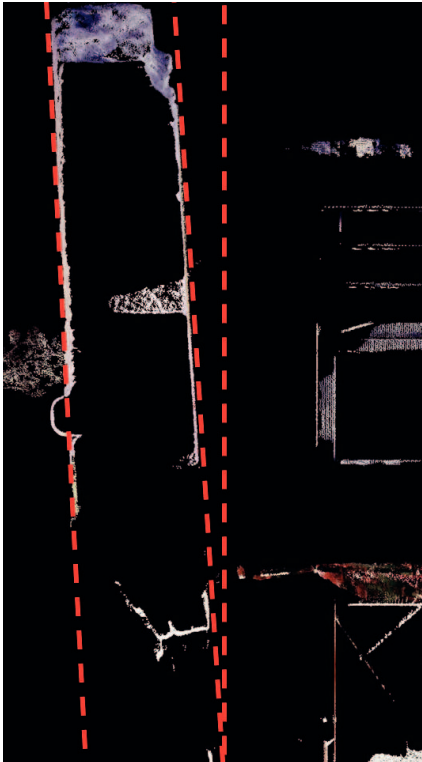
Fig. 88. Il ribaltamento semplice del paramento murario della torre campanaria.
