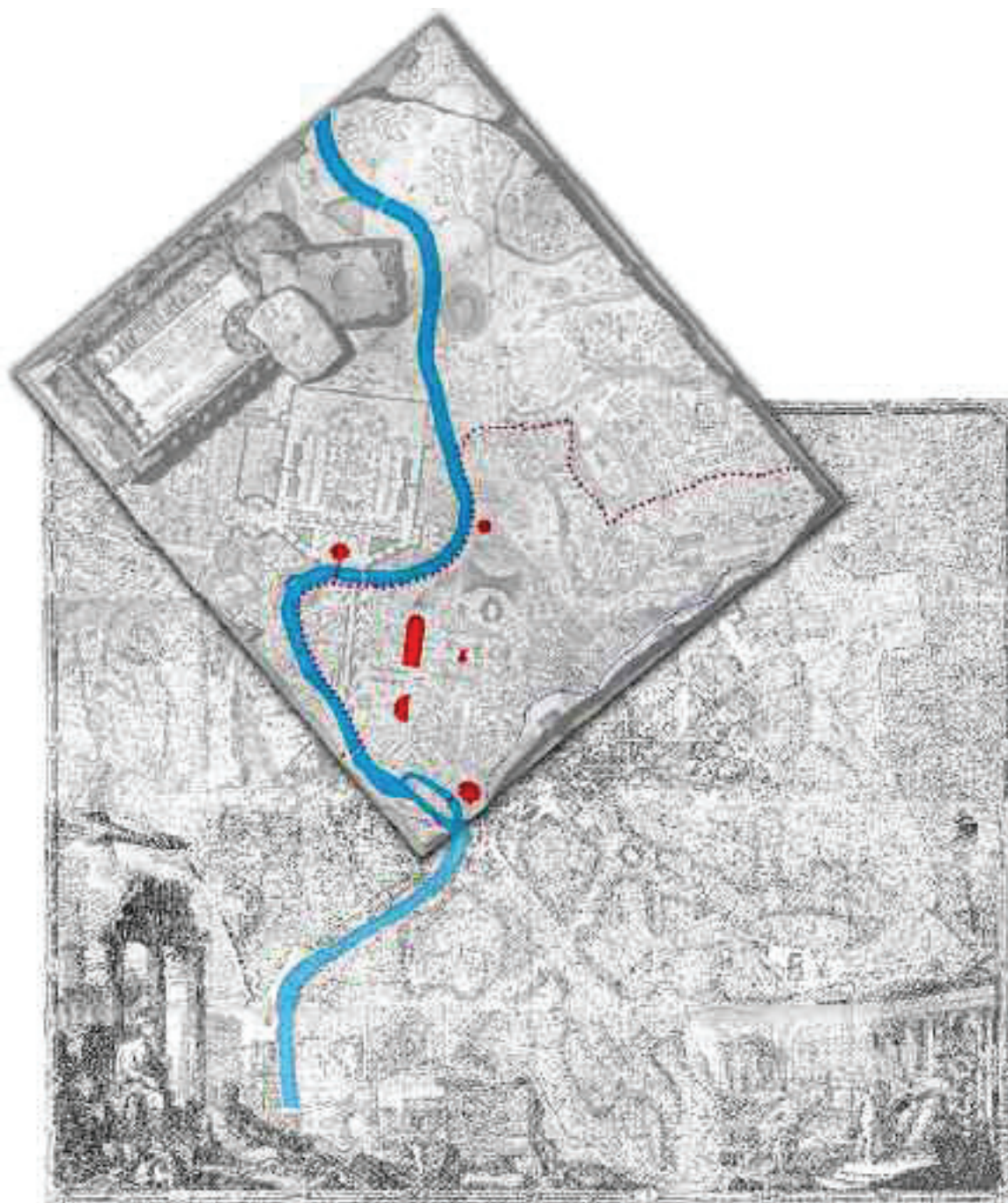
37/ Elaborazione grafica indicante la sovrapposizione della Icnografia sulla Nuova Pianta – Si noti: la linea puntinata viola per indicare il percorso delle mura aureliane, quella continua per quelle severiane; la campitura in azzurro per individuare il percorso del Tevere, mentre in rosso sono stati segnati i capisaldi di riferimento.
