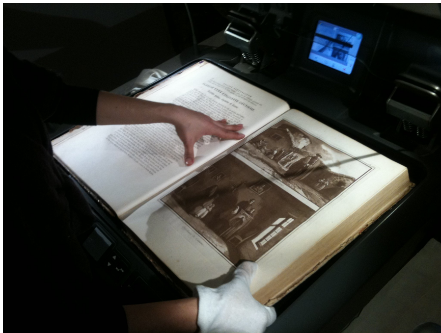
Figura 14.35: La fase di acquisizione delle immagini con lo scanner planetario di uno dei tomi
