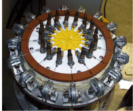
fig.5.03 - Apparato di Stretching Biassiale
