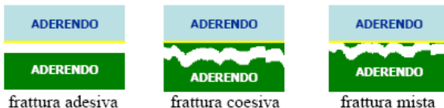
Fig. 1.72 Tipologie di frattura in un pannello sandwich
