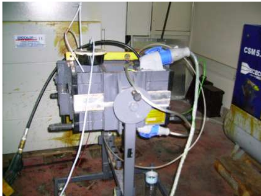
Fig.4.29 Macchina RTM in fase di iniezione
