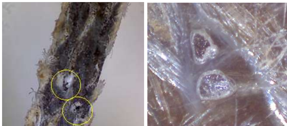
Fig. 4.116 Scansione al microscopio ottico di due sezioni di laminati rinforzati rispettivamente con Biotex e B6240C in cui si vede la presenza di macrovuoti
