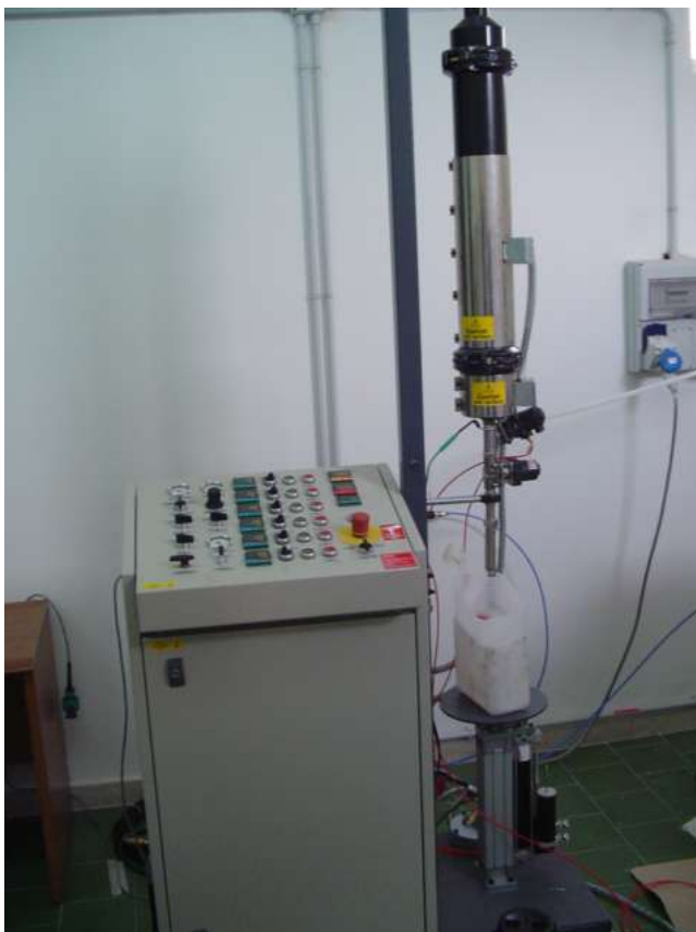
Fig.4.26 Macchina per il RTM (Hypaject III) in dotazione al D.I.I.M.
