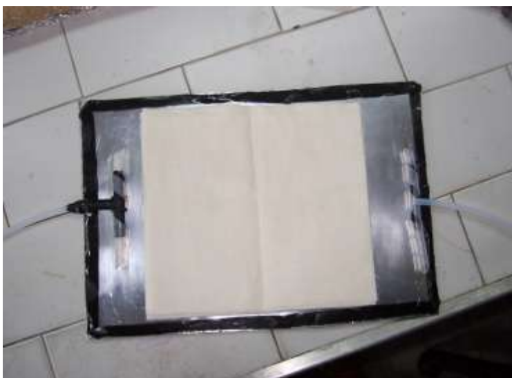
Fig.4.33 Fasi della preparazione dello stampo: posizionamento dei tessuti
