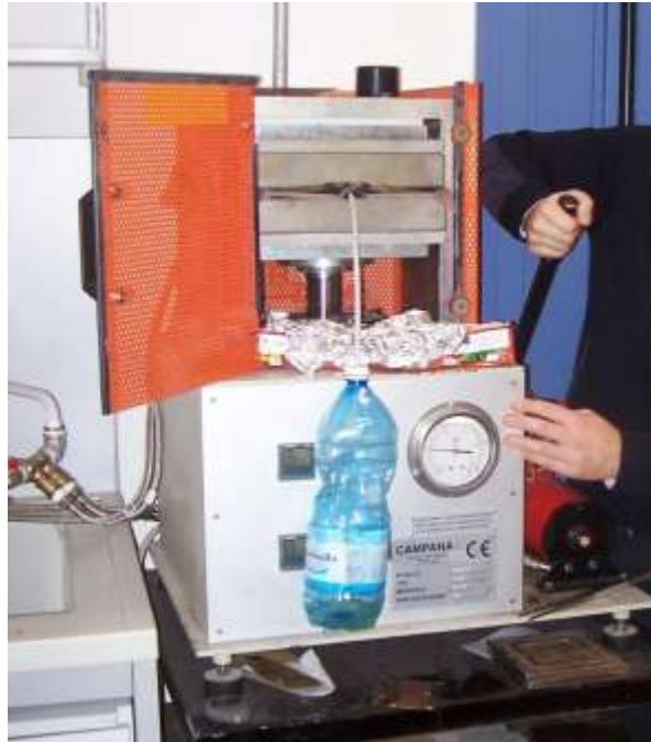
Fig. 4.38 Fase di pressaggio del laminato appena terminata l'infusione in Bag Molding
