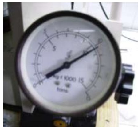
Fig.4.17 Pressa utilizzata per compattare la fibra e particolare del manometro
