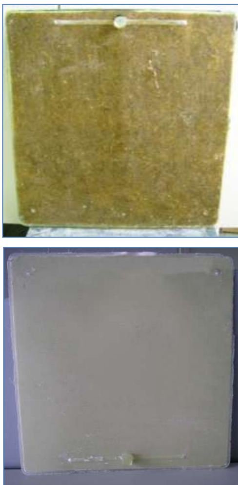
Fig.4.30 Laminati in composito rinforzato con tessuto Mat (alto) e B6240C (basso)
