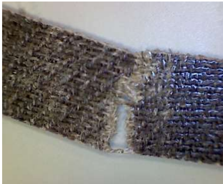
Fig. 4.118 Rottura non netta di un provino di composito rinforzato con tessuto Biotex testato a trazione
