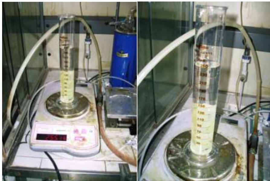
Fig.4.22 Alcune fasi della prova per determinare la densità della resina
