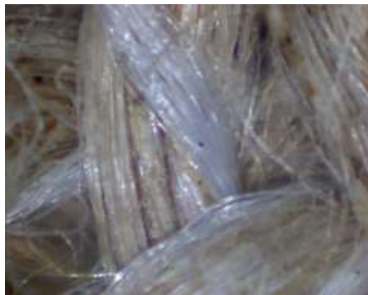
Fig.4.11 Immagine al microscopio ottico (200x) delle fibre del Biotex in cui si nota che le fibre non sono ritorte
