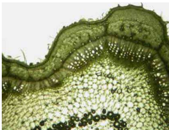
Fig. 1.20 Sezione trasversale di una cellula di canapa, con le fibre che circondano il fusto
