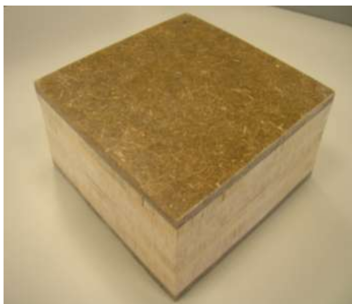
Fig. 4.146 Un prototipo di pannello sandwich realizzato presso il D.I.I.M. con pelli esterne in laminato rinforzato con tessuto Mat (spessore complessivo pari a 10 cm)
