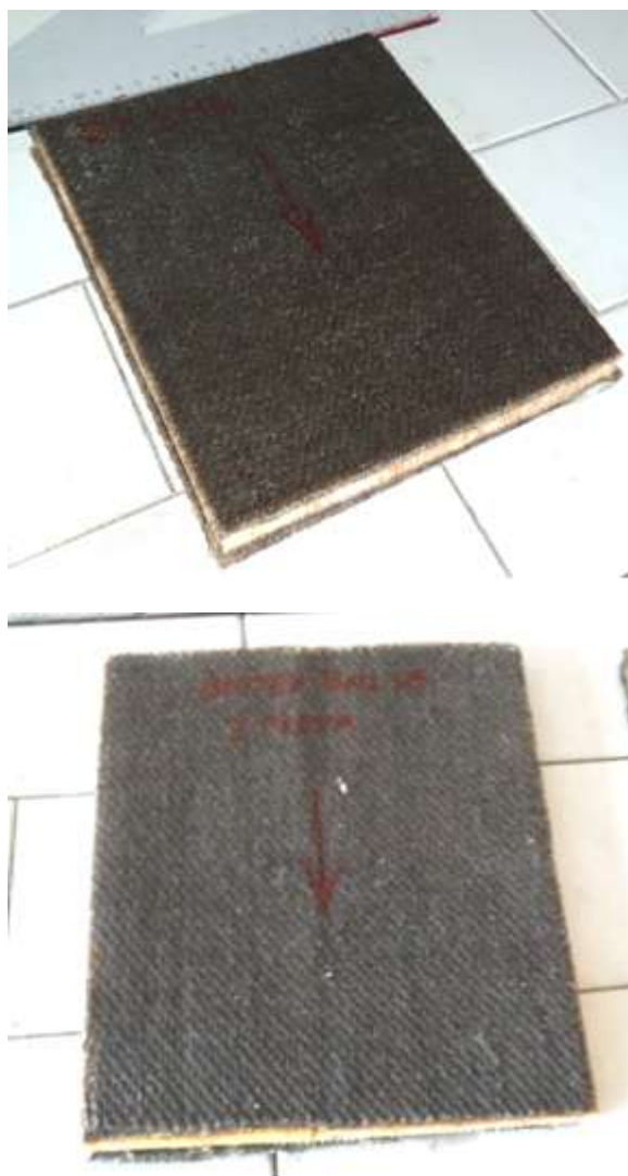
Fig. 4.156 Prototipi di pannelli sandwich in laminato con tessuti Biotex e balsa, realizzati in un solo step di iniezione con il processo Bag Molding
