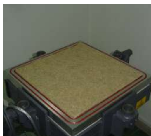
Fig.4.27 Posizionamento dei tessuti all'interno della cavità dello stampo metallico
