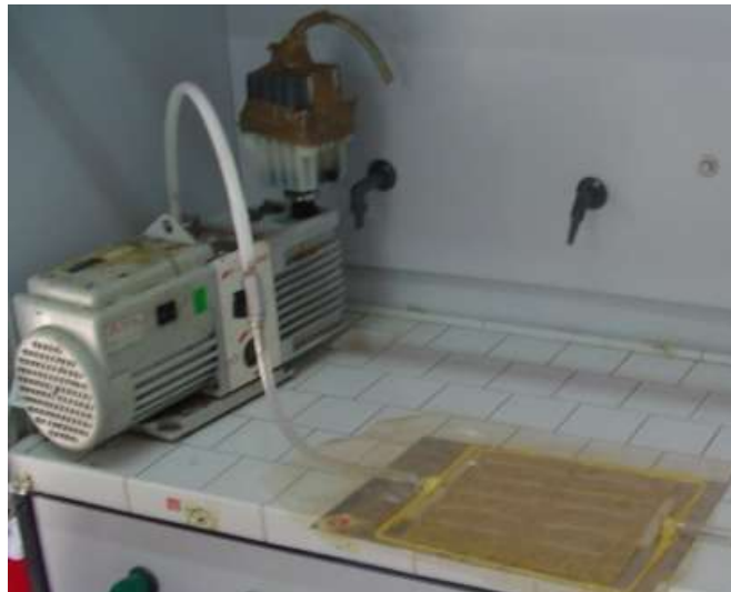
Fig. 4.35 Configurazione finale del sistema per il Bag Molding
