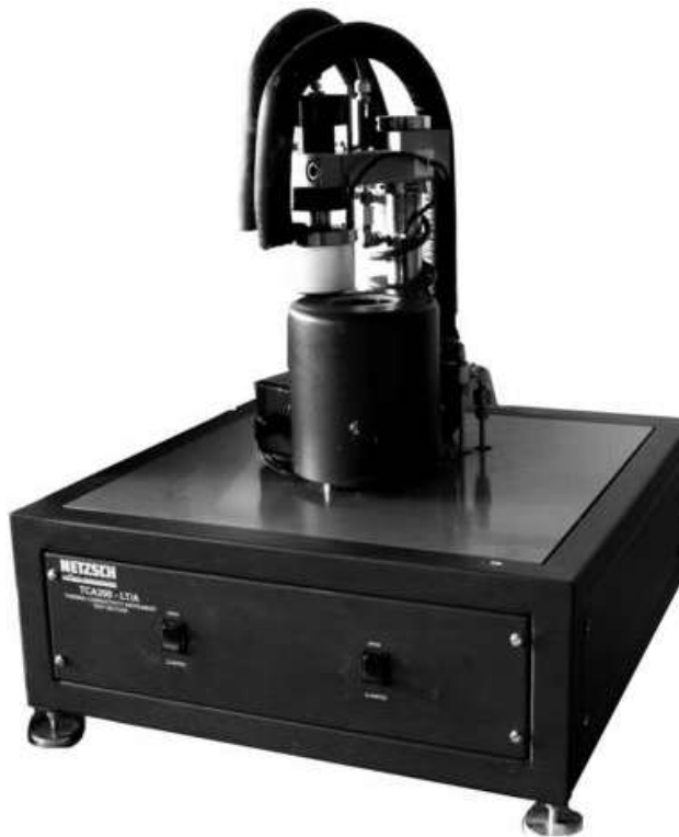
Fig. 4.56 Termoflussimetro TCA200 in dotazione all'Istituto PUK dell'Università di Clausthal
