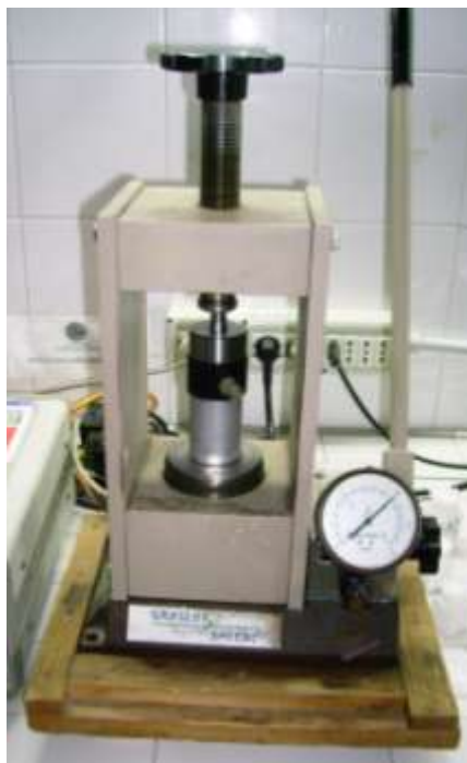
Fig.4.17 Pressa utilizzata per compattare la fibra e particolare del manometro
