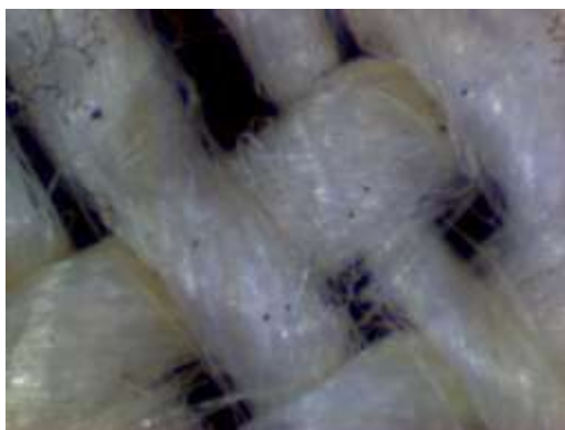
Fig.4.5 Immagine al microscopio ottico (100x) delle fibre ritorte del B607
