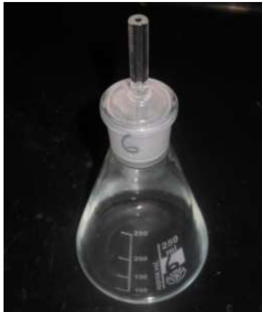
Fig. 4.41 Picnometro impiegato per le misurazioni di volume
