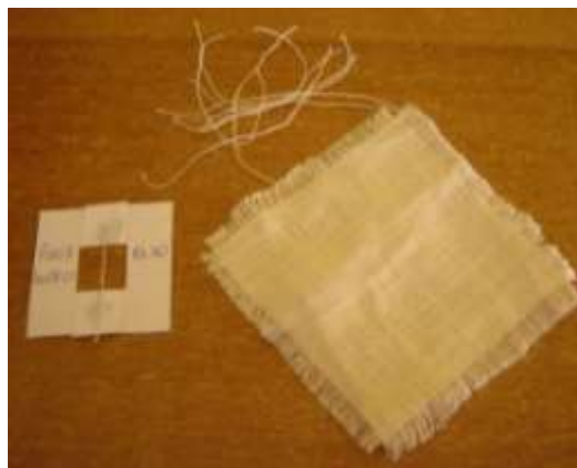
Fig.4.19 Cornice di carta per la prova di trazione della fibra
