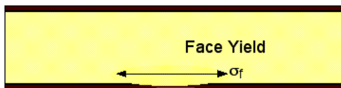
Fig. 3.34 Rottura delle facce o face yield (instabilità locale)
