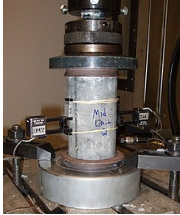
Figura 4.8: Provino cilindrico portato a rottura.
