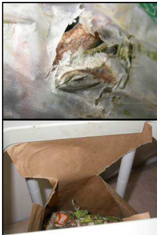
Figura 32: Rottura meccanica e degradativa in carta e materiale biodegradabile
