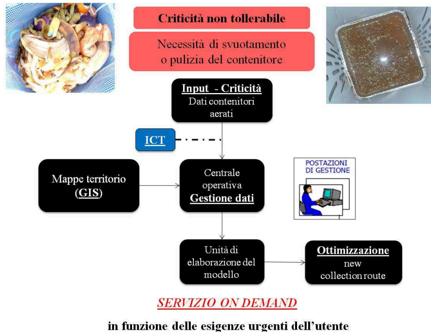
Figura 37: Schema di architettura della piattaforma telematica di acquisizione, gestione ed elaborazione dati
