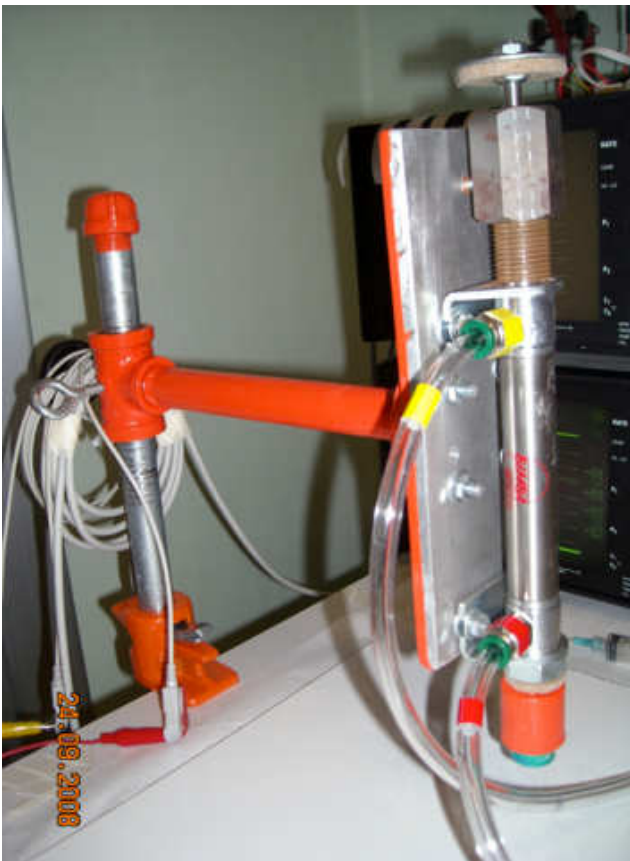
Figura 4. Strumentazione utilizzata per la compressione meccanica del torace e per la defibrillazione
