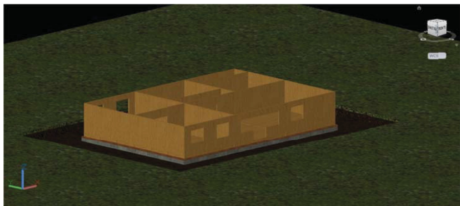
Figura 8.44 - Posa delle partizioni interne non portanti.
