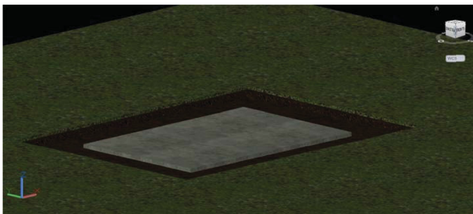
Figura 8.40 - Posa della fondazione a platea in c.a. prefabbricato.
