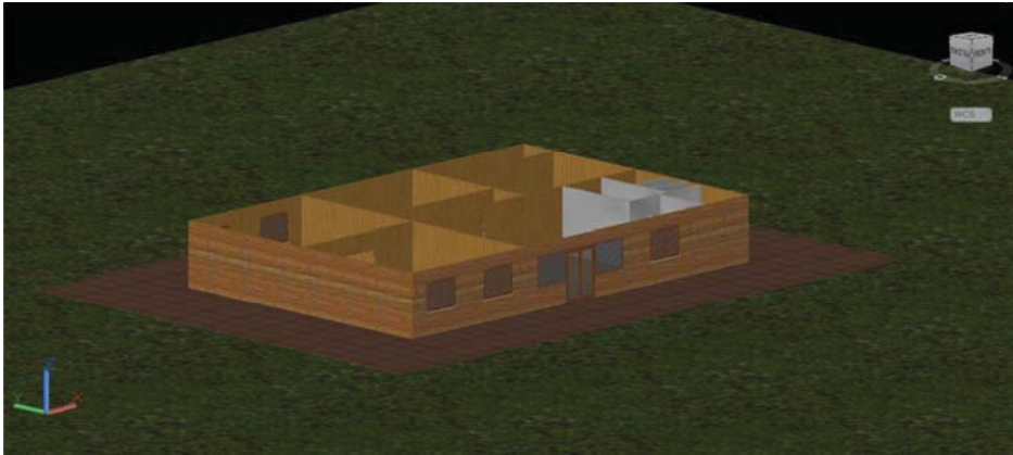
Figura 8.45 - Posa del modulo bagno.
