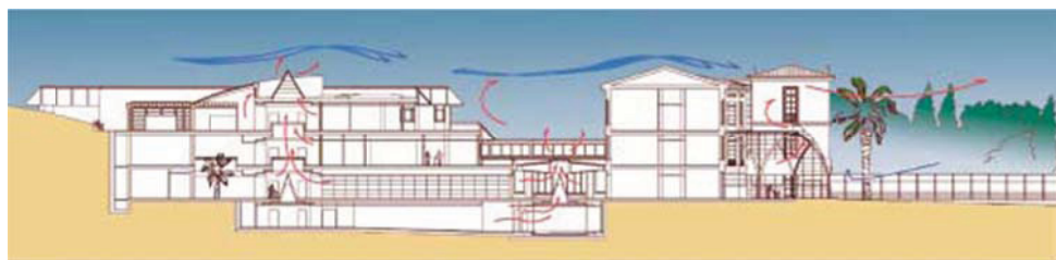
Figura 5.1.13 – Sezione e schema funzionale energetico.
