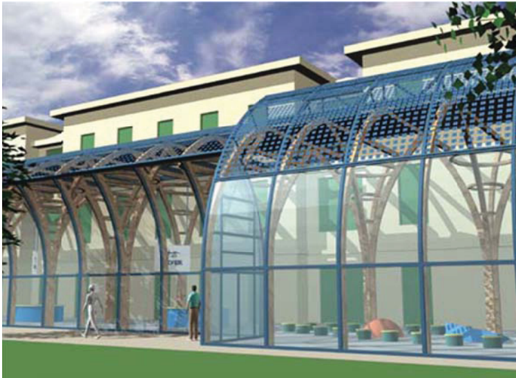
Figura 5.1.16 – Serra solare bioclimatica fotovoltaica.
