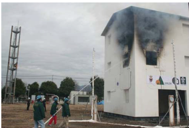
Figura 7.22 – Prova al fuoco effettuata su un edificio di tre piani costruito con pannelli X-LAM, Tsukuba in Giappone. 18
