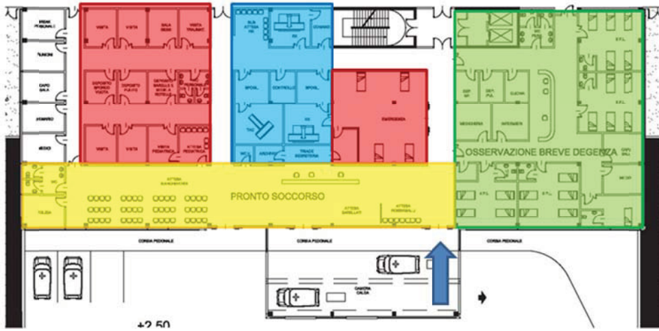
Figura 8.9 - Confronto fra lo sviluppo planimetrico dell'Ospedale di Prato e lo studio della maglia strutturale con i percorsi 7,00x7,00m.
