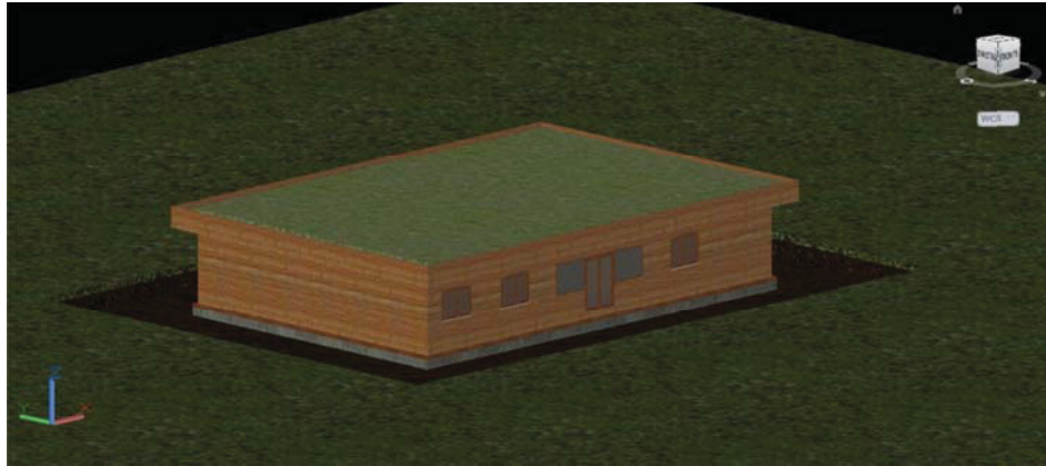
Figura 8.47 – Posa degli infissi, del rivestimento esterno e del tetto giardino.
