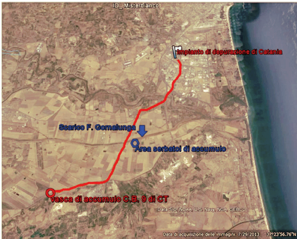
Figura 7.4 – nuova ipotesi progettuale di breve-medio termine relativa allo scarico dei reflui dell’impianto di depurazione consortile di Catania
