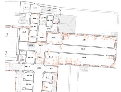
stralcio pianta quadro fessurativo
