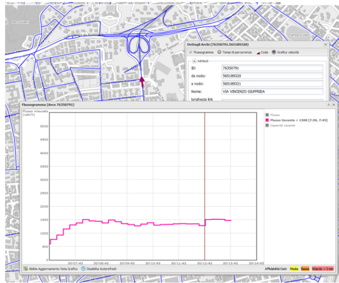
Figura 5.40 TrafficSupervisor: Monitoraggio real-time dei flussi di traffico
