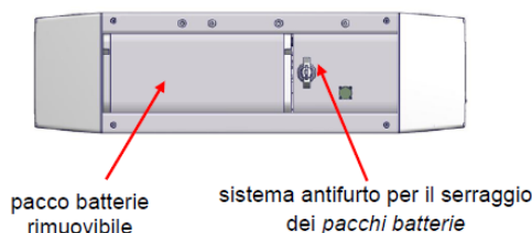
Figura 5.5 Vista posteriore MobilTraf300 versione "compact"
